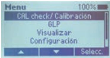
Funciones avanzadas como CAL Check™ para verificar el buen estado del equipo, GLP con la última fecha de calibración, configuración y posibilidad de ver códigos de los accesorios y reactivos.
