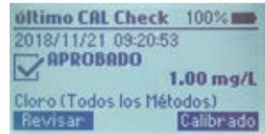
La pantalla CAL Check guía al usuario en la validación de la medida y en la calibración (si es necesaria) utilizando los patrones certificados HANNA.
